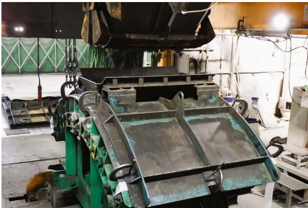
下水道用低炭素セグメント製造の様子
