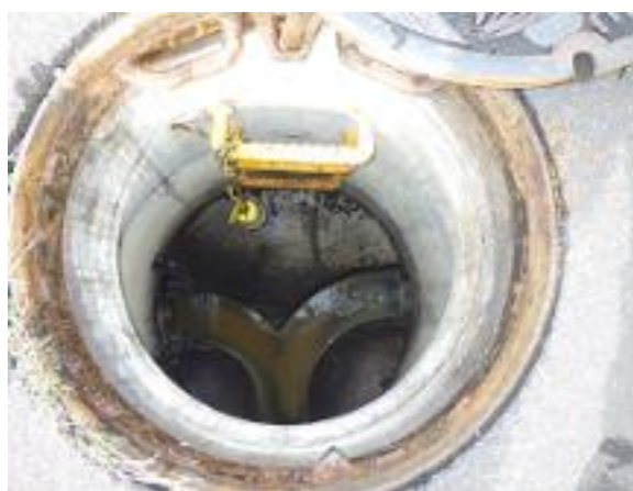
写真 2 硫化水素測定器の設置方法(例)
