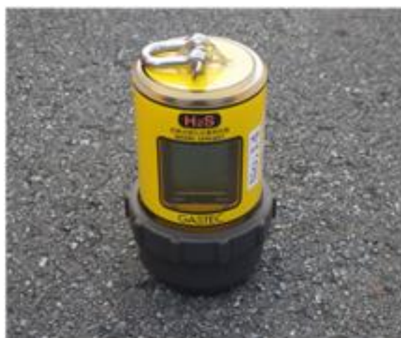
写真 1 硫化水素測定器
