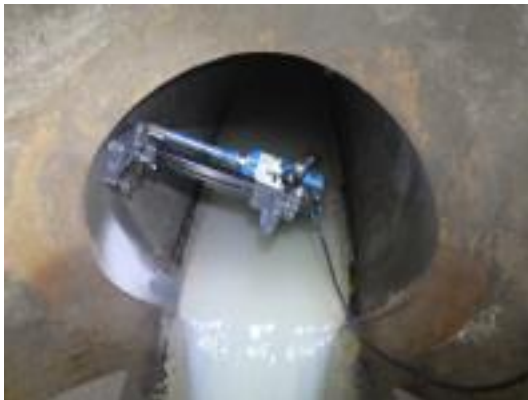
写真 5 コア供試体の採取状況
