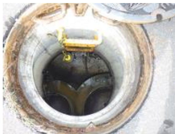
写真 2 硫化水素測定器の設置方法 (例)
