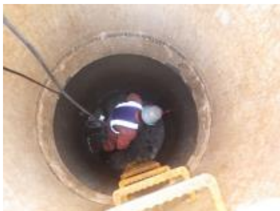
写真 5 コア供試体の採取状況
