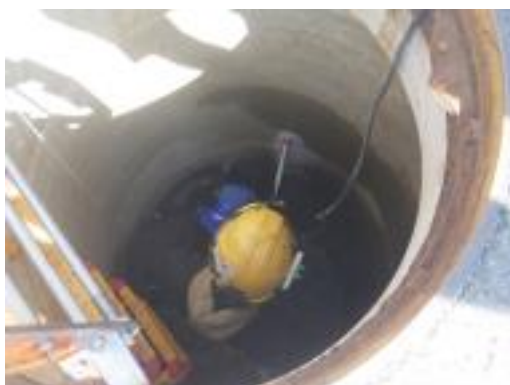
写真 5 コア供試体の採取状況
