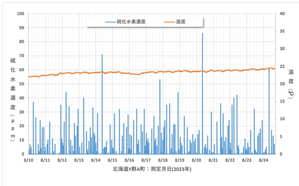
図3-1 北海道Y郡A町における硫化水素濃度と温度の測定結果
