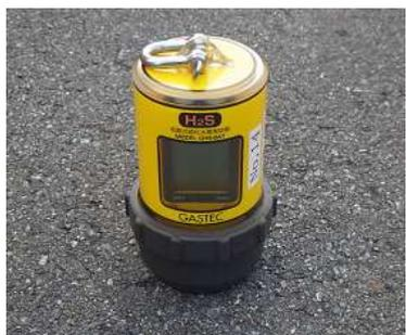
写真2-4 硫化水素濃度測定器
