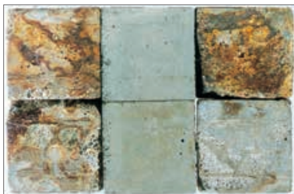
●曝気槽にて2年間暴露試験を行ったテストピースの腐食状況比較
