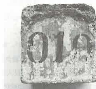
写真3 普通コンクリート
